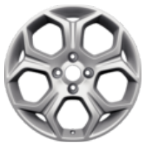
Leichtmetallrad 17" 5-Speichen-Y-Design, silber 6,5 J x 17, ET 40, für Reifengröße 205/45 R17 – nur in Verbindung mit Lenkeinschlagbegrenzer
