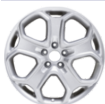
Leichtmetallrad 18\" 5-Speichen-Y-Design, silber 7,5 x 18", ET 52,5, für Reifen 225/40 R18 – nur in Verbindung mit Lenkeinschlagbegrenzer
