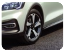
Leichtmetallrad 17" 5-Speichen-Design, Black Machined 7 J x 17", ET 45, für Reifengröße 215/50 R17 – Active
