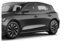
Leichtmetallrad 17" 10-Speichen-Design, Absolute Black Machined 7 J x 17, ET 50, für Reifengröße 215/50 R17 91V – Nicht für Active
