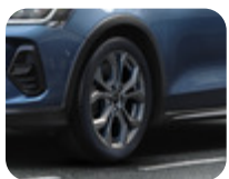
Leichtmetallrad 17" 5 x 2-Speichen-Design, Rock Metallic Light 7 x 17", ET 50, für Reifengröße 215/50 R17 – Nicht für Active und Trend.
