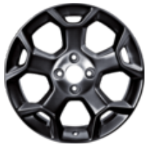
Leichtmetallrad 16" 5-Speichen-Y-Design, Panther Black 6,5 x 16", ET 40, für Reifen 195/45 R16
