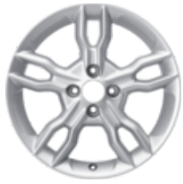
Leichtmetallrad 16" 5 x 2-Speichen-Design, Sparkle Silver 6,5 J x 16", ET 40, für Reifengröße 195/45 R16
