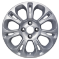
Leichtmetallrad 15" 7 x 2-Speichen-Design, silber 6 x 15", ET 35, für Reifen 195/50 R15
