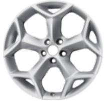
Leichtmetallrad 19" 5-Speichen-Y-Design, Sparkle Silver Machined front 8 J x 19, ET 55, für Reifengröße 235/40 R19, nur für Fahrzeuge mit Sportfahrwerk, nicht für 1,6 l Benzinmotoren verfügbar, nur in Verbindung mit Lenkeinschlagbegrenzer
