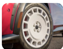
Leichtmetallrad 19" 15-Speichen, Oxford Weiß 7,5 J x 19", ET 47,5, für Reifengröße 235/55 R19. – Rally, ab 08/2023 –
