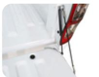
**RIVAL\* Heckklappendämpfer für langsames Absenken**
