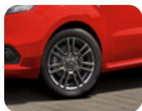
Leichtmetallrad 16" 7 x 2-Speichen-Design, Magnetic 6,5 x 16", Einpresstiefe 40 für Reifen 195/55 R16.
