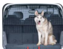
**Grille de séparation Pleine hauteur, à monter derrière les sièges de 2<sup>e</sup> rangée, peut également être fixée derrière les sièges de 1<sup>re</sup> rangée avec le kit d'extension séparé**
