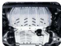
**Plaque de protection du moteur et radiateur en aluminium**
