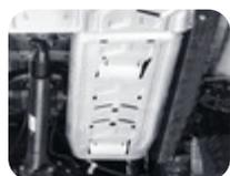
**Plaque de protection du moteur pour réservoir de carburant, aluminium**
