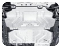
**Plaque de protection du moteur, transmission et boîte de transfert en aluminium**
