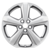
Jante en alliage 18" Modèle à 5 branches, Sparkle Silver 7.5 x 18", déport 55, pour pneus 235/50 R18 et 235/60 R18
