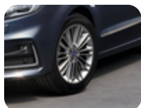
Jante en alliage 18" Modèle à 10 x 2 branches, acier inoxydable foncé 7.5 x 18", déport 55, pour pneus 235/50 R18
