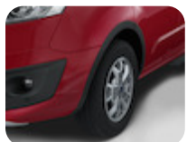
Extension de passage de roue avant et arrière Jeu de 4, requis pour l'installation de la tôle de protection avant – Pour véhicules sans bavettes arrière
