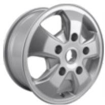
Jante en alliage 16" Modèle à 5 branches, argent brillant 6.5J x 16", déport 60
