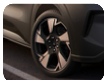
Jante en alliage 19" Modèle à 5 branches, Asphalt Matt Black 7,5 x 19", déport 52,5, pour pneus 235/50 R19.
