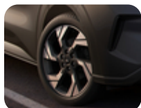
Jante en alliage 19" Modèle à 6 branches, Ebony Black 7,5 x 19", déport 52,5, pour pneus 235/50 R19.
