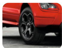
Lichtmetalen velg 17" 5-spaaks design, Tarnished Dark Metallic 7 x 17", ET 37.5, voor bandenmaat 205/50 R17
