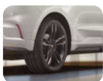
Lichtmetalen velg 21" 5 x 2-spaaks design, Low Gloss Premium gelakt 9 x 21", ET 55, voor bandenmaat 265/40 R21
