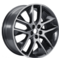
Lichtmetalen velg 20" 5x2-spaaks design, Dark Stainless 8.5x20", ET 52,5, voor bandenmaat 255/45 R20. Extra onderdelen noodzakelijk voor de montage. Vraag uw Ford dealer voor meer informatie
