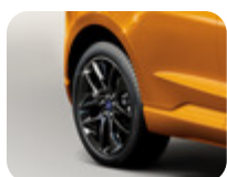
Lichtmetalen velg 20" 5x2-spaaks Y-design, Tarnished Dark 8.5x20", ET 52,5, voor bandenmaat 255/45 R20
