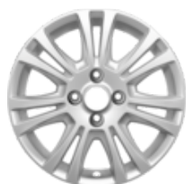
Lichtmetalen velg 16" 7-spaaks design 6,5 x 16", offset 47,5 voor 195/50R16 of 195/45R16 banden
