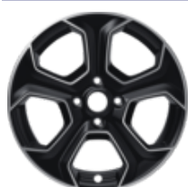
Lichtmetalen velg 17" 5-spaaks design, matzwart gefreesd ST 200 7 x 17"f, inpersdiepte 47.5, voor 205/40 R17 banden – Enkel in combinatie met ESP en stuuruitslagbegrenzer
