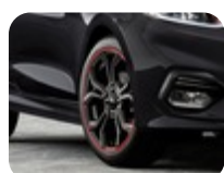
Lichtmetalen velg 17" 5 x 2-spaaks Y-design, zwart gespoten met rode accentring 7 x 17", inpersdiepte 47,5, voor bandenmaat 205/45 R17
