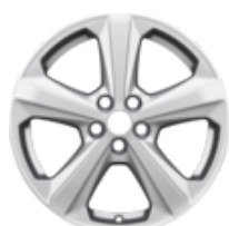
Lichtmetalen velg 18" 5-spaaks design, Sparkle Silver 7.5 x 18", ET 55, voor bandenmaat 235/50 R18 en 235/60 R18. Extra onderdelen noodzakelijk voor de montage. Vraag uw Ford dealer voor meer informatie – Behalve auto's met vierwielaandrijving
