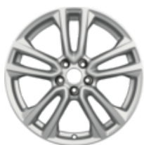
Lichtmetalen velg 18" 5 x 2-spaaks design, glinsterend zilver afwerking 7,5 x 18", inpersdiepte 52,5, voor 235/50 R18 banden
