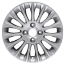
Leichtmetallfelge 16" 15-Speichen-Design, silber 6,5 x 16", ET 41,5, für Reifen 195/45 R16
