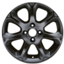
Leichtmetallfelge 16" 7-Speichen-Design, schwarz 6,5 J x 16, ET 41,5, für Reifengrösse 195/45 R16
