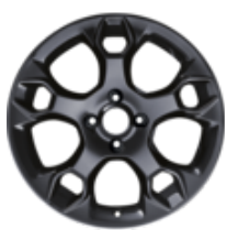
Leichtmetallfelge 17" 5-Speichen-Y-Design, schwarz 7 J x 17, ET 47,5, für Reifengrösse 205/40 R17 – Nur in Verbindung mit ESP und Lenkeinschlagbegrenzer
