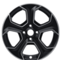
Leichtmetallfelge 17" 5-Speichen-Design, Matt Black Machined ST 200 7 J x 17", ET 47,5, für Reifengrösse 205/40 R17 – Nur in Verbindung mit ESP und Lenkeinschlagbegrenzer
