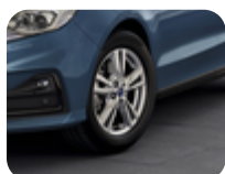
Leichtmetallfelge 17" 5 x 2-Speichen-Design, silber 7,5 x 17", ET 55, für Reifengrösse 235/55 R17.
