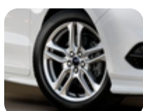
Leichtmetallfelge 18" 5 x 2-Speichen-Design, silber 7,5 J x 18, ET 55, für Reifengrösse 235/60 R18
