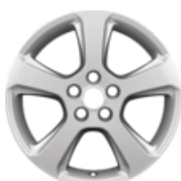
Leichtmetallfelge 17" 5-Speichen-Design, silber 7,5 J x 17, ET 55, für Reifengrösse 235/55 R17, vollständiges Set
