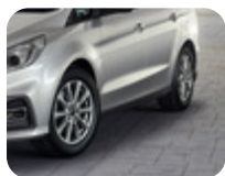
Leichtmetallfelge 17" 10-Speichen-Design, silber 7,5 J x 17, ET 55, für Reifengrösse 235/55 R17.
