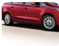
Leichtmetallfelge 17" 10-Speichen-V-Design, silber 7,5 J x 17, ET 55, für Reifengrösse 235/55 R17
