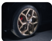
Leichtmetallfelge 19" 5 x 2-Speichen-Design, Aurora Gold 8 J x 19", ET 47,5, für Reifengröße 225/40 R19 – ST
