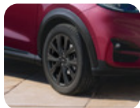
Leichtmetallfelge 17" 5 x 2-Speichen-Design, Pearl Grey 7 x 17", ET 47,5, für Reifengröße 215/55 R17 – Nicht für ST und ST X
