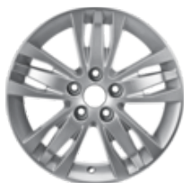
Leichtmetallfelge 16" 5 x 3-Speichen-Design, silber 6,5 x 16", ET 50, für Reifen 215/60 R16 – ab 2006 –
