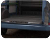
**Holzboden für Ladefläche mit integrierten Airline-Schienen**
