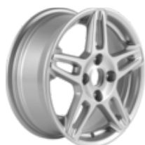
Jante en alliage 15" Design à 5 x 2 rayons, argent brillant 6 x 15", déport 47,5, pour pneus 195/55 R15 – Sauf ST
