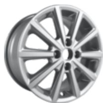
Jante en alliage 16" Modèle à 10 rayons, argent brillant 6.5 x 16", déport 47,5, pour pneus 195/45 R16 et 195/50 R16
