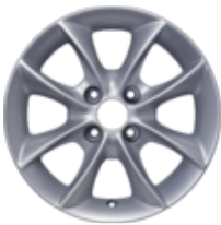
Jante en alliage 14" modèle 8 rayons, argent 5,5 x 14", déport 35, pour pneus 175/65 R14
