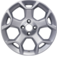
Jante en alliage 16" modèle 5 rayons en Y, argent 6,5 x 16", déport 40, pour pneus 195/45 R16
