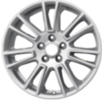
Jante en alliage 16" modèle 7 x 2 rayons, argent brillant 6,5 x 16", déport 50, pour pneus 215/55 R16 (205/55 R16 pour moteurs à essence 1,6 l)
