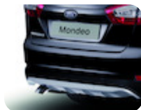
Diffuseur inférieur de bouclier arrière argent Pour véhicules avec double sortie d'échappement et sans dispositif d'aide au stationnement
