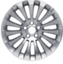
Jante en alliage 17" modèle 15 rayons, argent 7,5 x 17", déport 55, pour pneus 235/45 R17, sauf pour moteurs à essence 1,6 l
