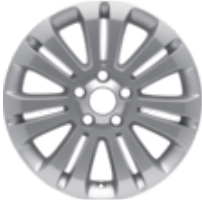
Jante en alliage 16" modèle 7 x 2 branches, argent 6,5 x 16", déport 50, pour pneus 215/55 R16 (205/55 R16 pour moteurs essence 1,6 l)
