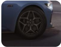
**Jante en alliage 19" avant, modèle à 5 branches en Y, Machined Tarnished Dark**
