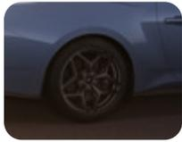
**Jante en alliage 19" arrière, modèle à 5 branches en Y, Machined Tarnished Dark**
