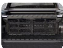
**Pickup Attitude\* Load Bed Divider pour système à glissières en C monté d'origine**
