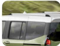
**Barres de toit longitudinales Barre simple pour côté gauche, argent**
