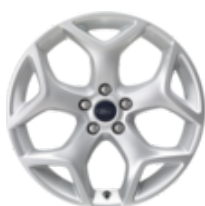
Cerchi in lega 18" a 5 razze, argento 8 x 18", disassamento 52.5 – Solo per Focus ST
