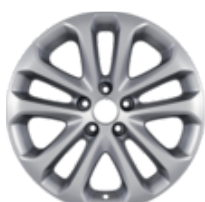
Kolo z lehké slitiny 17" provedení s 5x2 paprsky ve stříbrné barvě 7 x 17", zális 50 pro pneumatiky 215/50 R17. – nelze pro HEV
