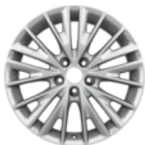
Kolo z lehké slitiny 17" provedení Premium s 10 paprsky ve stříbrné barvě 7 x 17", zális 50 pro pneumatiky 215/50 R17. – nelze pro pohon HEV
