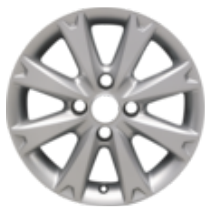
Kolo z lehké slitiny 15" provedení s 8 paprsky, stříbrné 6 x 15", zális 47.5 pro pneumatiky 195/50 R15
