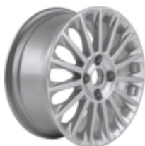
Kolo z lehké slitiny 16" provedení s 15 paprsky, Sparkle Silver 6.5 x 16", zális 47,5 pro pneumatiky 195/50 R16 a 195/45 R16.
