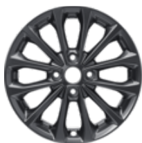
Kolo z lehké slitiny 16" Provedení s 12 paprsky, barva Rock Metallic 6.5 x 16", zális 47,5, pro pneumatiky 195/45 R16 nebo 195/50 R16.
