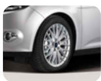
Kolo z lehké slitiny 17" provedení s 10x2 paprsky Y ve stříbrné barvě 7 x 17" zális 50 pro pneumatiky 215/50 R17.
