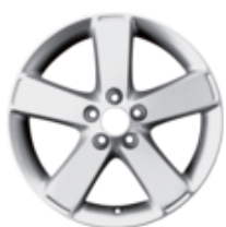
Kolo z lehké slitiny 17" provedení s 5 paprsky, se stříbrným frézovaným čelem 7 x 17", zális 55 pro pneumatiky 225/50 R17. – pouze ve spojení s omezovačem dráhy hřebenové tyče, od 2006 dále
