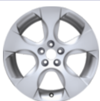
Kolo z lehké slitiny 18" provedení s 5 paprsky ve stříbrné barvě Sparkle Silver 8 x 18", zális 55 pro pneumatiky 235/45 R18. – pouze ve spojení s omezovačem dráhy hřebenové tyče, od 2006 dále
