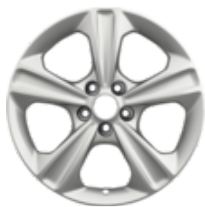
Kolo z lehké slitiny 17" provedení s 5-ti paprsky, stříbrné 7,5 x 17", zális 52,5. – Pro pneumatiky o rozměru 235/55 R17.
