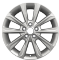
Kolo z lehké slitiny 17" provedení s 5x2 paprsky, stříbrný odstín Sparkle Silver 7,5 x 17", zális 52,5 pro pneumatiky 235/55 R17.
