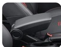
**Rati\* Armlehne Design "Armster OE1", mit integriertem USB-Ladeanschluss für mobile Endgeräte**
