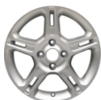
Leichtmetallrad 16" 5 x 2-Speichen-Design, silber 6,5 J x 16, ET 41,5, für Reifengröße 195/45 R16
