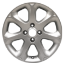
Leichtmetallrad 16" 7-Speichen-Design, silber 6,5 J x 16, ET 41,5, für Reifengröße 195/45 R16
