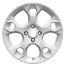
Leichtmetallrad 17" 5-Speichen-Y-Design, Frozen White 7 J x 17, ET 47,5, für Reifen 205/40 R17 – Nur in Verbindung mit ESP und Lenkeinschlagbegrenzer
