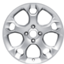
Leichtmetallrad 15" 5-Speichen-Y-Design, silber 6 J x 15, ET 47,5, für Reifengröße 195/50 R15
