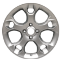
Leichtmetallrad 17" 5-Speichen-Y-Design, silber 7 J x 17, ET 47,5, für Reifengröße 205/40 R17 – Nur in Verbindung mit ESP und Lenkeinschlagbegrenzer
