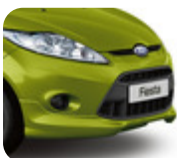
Frontschürze Grundiert, in Wagenfarbe zu lackieren, kann in Verbindung mit oder ohne Nebelscheinwerfer verwendet werden
