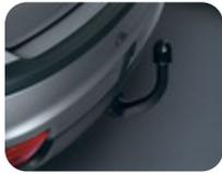
**Anhängervorrichtung mit abnehmbarem Kugelkopf**
