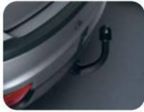
**Anhängervorrichtung mit festem Kugelkopf**
