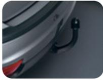
**Anhängervorrichtung mit abnehmbarem Kugelkopf**
