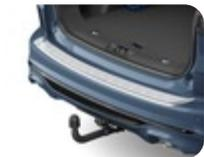
**Heckstoßfängerschutz in Passform, Edelstahlblech**
