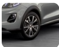
Leichtmetallrad 17" 5 x 2-Speichen-Design, Magnetic/Machined 7 J x 17", ET 47,5, für Reifengröße 215/55 R17 94H – Nicht für ST und ST X.
