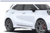
Leichtmetallrad 19" 5-Speichen-Y-Design, Magnetite Matt 8 J x 19", ET 47,5, für Reifengröße 225/40 R19 93H – für ST
