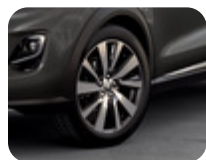
Leichtmetallrad 18" 5 x 2-Speichen-Design, Pearl Grey Machined 7 J x 18", ET 47,5, für Reifengröße 215/50 R18 92H – Nicht für ST und ST X.
