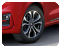
Leichtmetallrad 17" 5 x 2-Speichen-Design, Absolute Black Machined 7 J x 17", ET 47,5, für Reifengröße 215/55 R17 94H – Nicht für ST und ST X.
