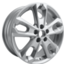
Leichtmetallrad 17" 5 x 2-Speichen-Design, silber 6,5 J x 17, ET 50, für Reifengröße 205/55 R17.
