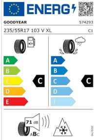
Kraftstoffeffizienz: C, Nasshaftung: C, Abrollgeräusch: B, dB: 71
