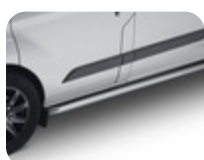
ARP* Schwellerschutzrohr aus poliertem Edelstahl, Röhren-Design mit gebogenen Enden
