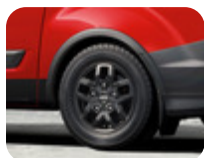
Leichtmetallrad 16" 5 x 2-Speichen-Design, Ebony Black High Gloss 6,5 x 16", ET 60, für Reifengröße 215/65 R16 und 235/65 R16 – Nicht für Plug-in-Hybrid-Elektrofahrzeug (PHEV)
