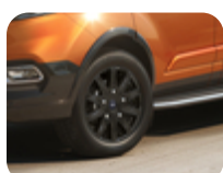
Leichtmetallrad 17" 10-Speichen-Design, Panther Black 7 J x 17, ET 55, für Reifengröße 215/60 R17 und 235/55 R17 – Nur für Fahrzeuge mit standardmäßiger Radhausverbreiterung. Nicht für Plug-in-Hybrid-Fahrzeuge (PHEV)
