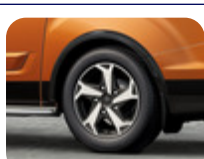
Leichtmetallrad 17" 5-Speichen-Design, Black Gloss Machined 7 J x 17, ET 55, für Reifengröße 215/60 R17 und 235/55 R17 – Nicht für Plug-in-Hybrid-Elektrofahrzeug (PHEV)
