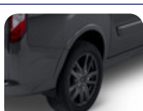
Leichtmetallrad 18" 5 x 2-Speichen-Design, Magnetic 7,5 J x 18, ET 56, für Reifengröße 235/50 R18 – Für Sport Van. Nicht für Plug-in-Hybrid
