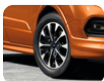
Leichtmetallrad 17" 10-Speichen-Design, Black Machined 7 J x 17, ET 55, für Reifengröße 215/60 R17 und 235/55 R17 – Nur für Fahrzeuge mit standardmäßiger Radhausverbreiterung. Nicht für Plug-in-Hybrid-Fahrzeuge (PHEV).
