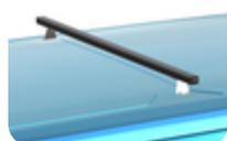
**Q-Top® (Q-Tech)\* Dachgrundträger mit einem Querträger**
