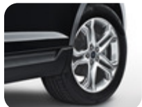
Alufælg 19" 5 x 2-eget design, Sparkle Nickel 8 x 19", indpresningsdybde 52,5, til dækstørrelse 235/55 R19 – Ikke Vignale
