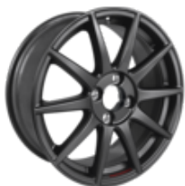
17" Ford Performance-hjul flow-form letvægtsfælg med Ford Performance logo, 10-egget design, Magnetite Matt 7 x 17", indpresningsdybde 47,5 – Ikke til ST og Active, til dækstørrelse 205/45 R17
